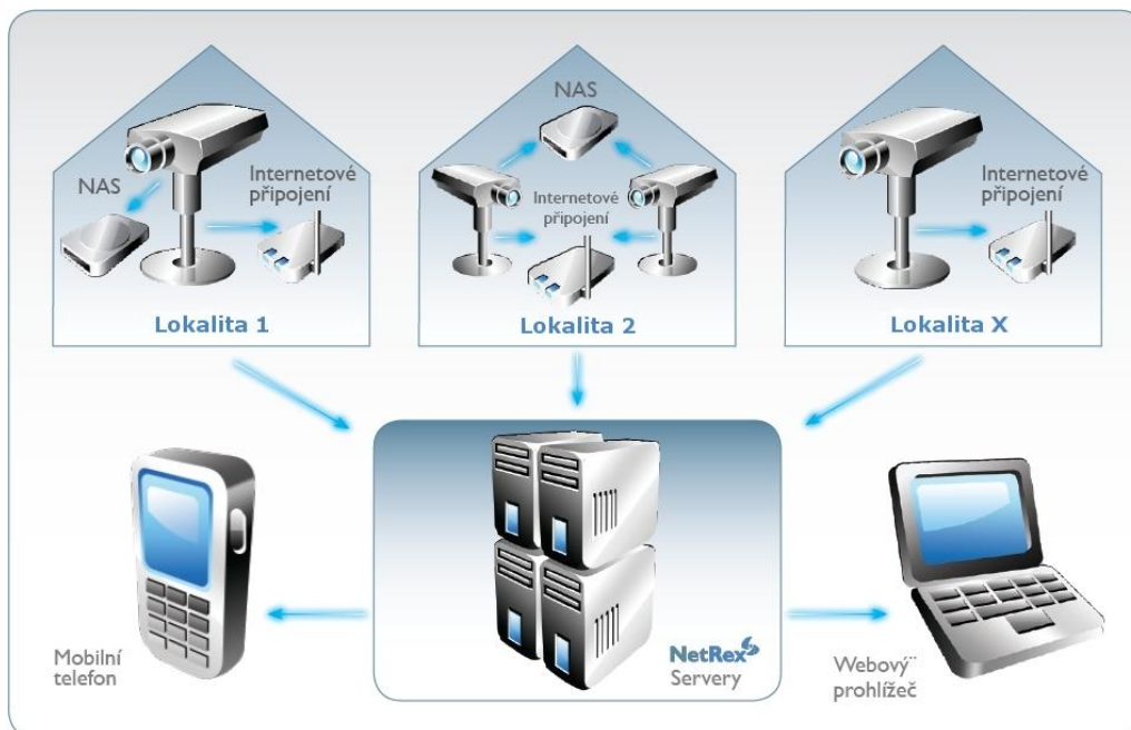
Obrázek č. 1 – modelové schéma řešení NetRex pro několik lokalit (NAS = volitelné lokální záznamové zařízení)
