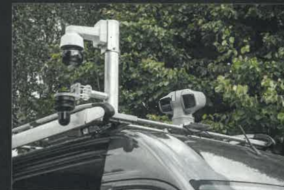
Vozidlo demonstrující platformu EISS, v níž slouží kamery k vizuálnímu ověření přesné lidarové detekce. Základem je lidar v systému Accur8vision zavěšený přes hranu střechy. Nad ním je otočná kamera AXIS Q6315-LE s jednatřicetinásobným optickým zoomem. Za nimi je potom šedá otočná kamera AXIS Q6215 schopná využívat IR přísvit na několik stovek metrů
