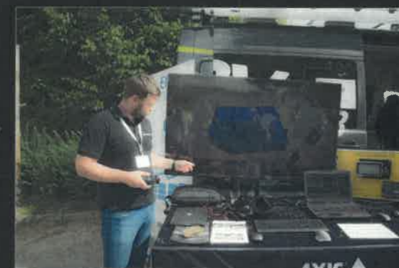
Ukázka vizualizace Accur8vision. Kamery Axis pomáhají při sběru textur pro modely prostředí. Na stole je vidět ruční lidar, který je možné využít k dořizování detailů modelu přímo v terénu
